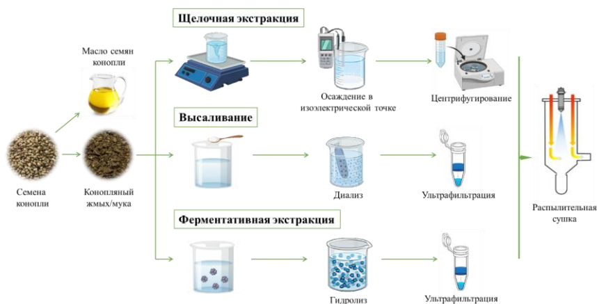
Рис. 2. Методы извлечения белковых продуктов из жмыха или шрота семян технической конопли Protein extraction methods from industrial hemp seed cake or meal
