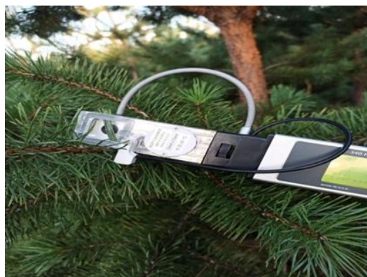
Рис. 2. Измерение параметров газообмена и транспирации сосны обыкновенной с помощью инфракрасного газового анализатора CI-340 Measurement of gas exchange and transpiration parameters in Scots pine using the CI-340 portable infrared gas analyzer
