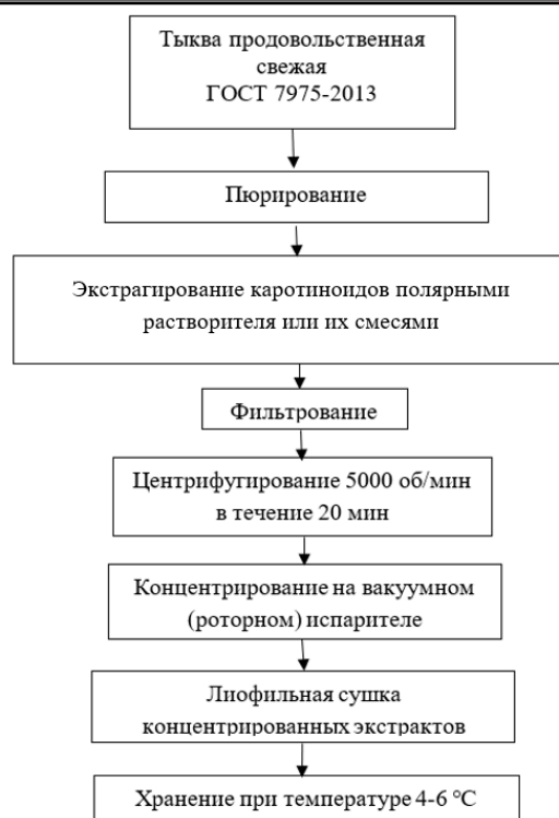
Рис. 5. Технологическая схема получения каротиноидного красителя из мякоти тыквы Technology of obtaining carotenoid dye from pumpkin
