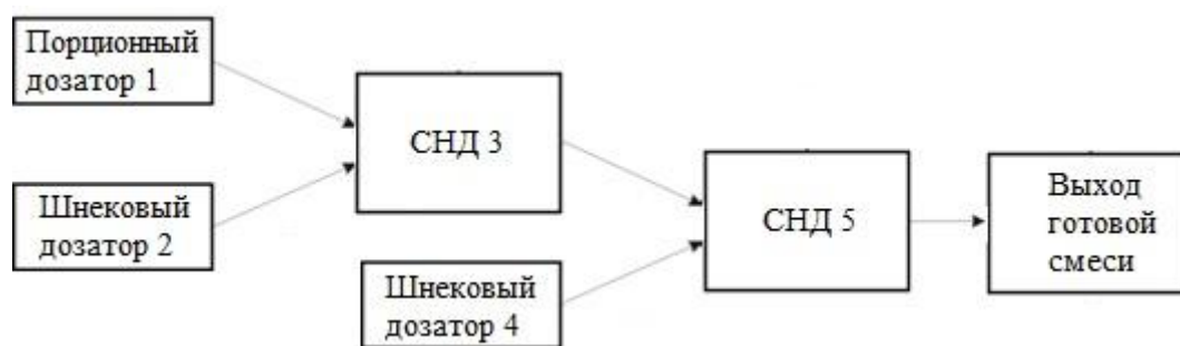
Рис. 1. Схема смесительного агрегата центробежного типа
