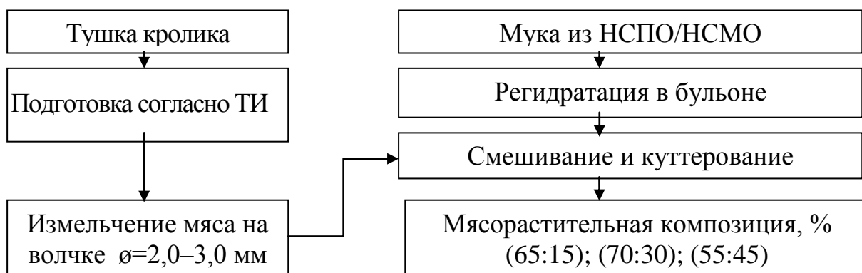
Рис. 2. Технологическая схема получения мясорастительной композиции с мукой из нерастворимого соево-овощного (перцевого или морковного) остатка
