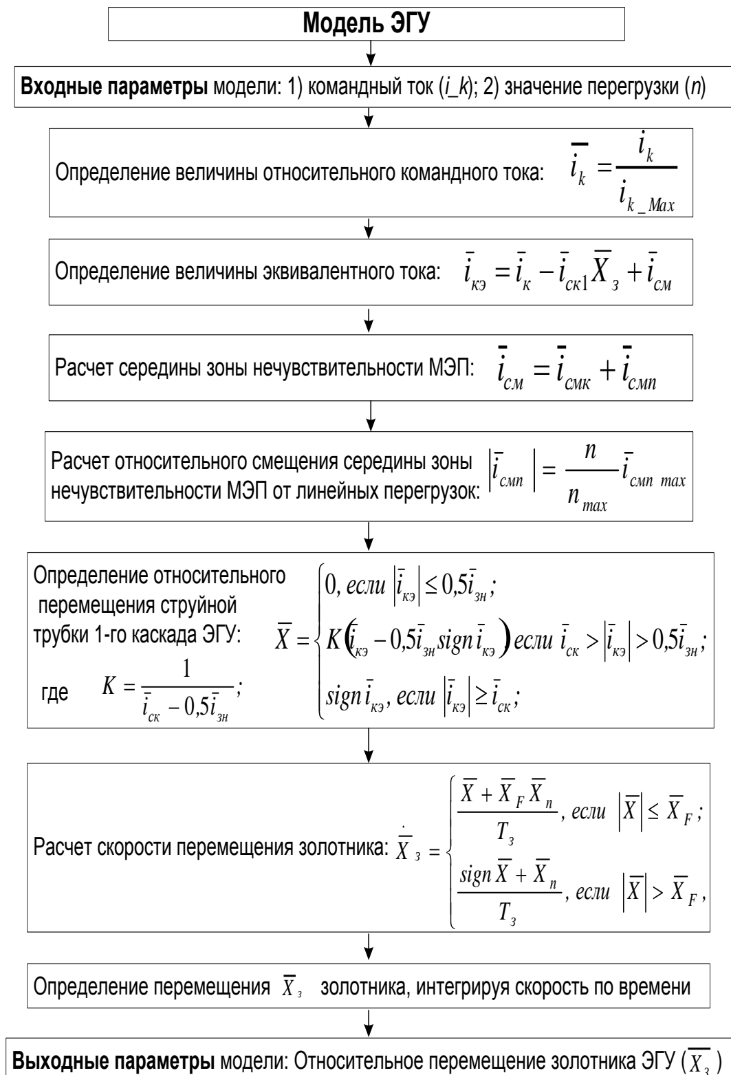
Рис. 3. Математическая модель работы ЭГУ с БФТУ
