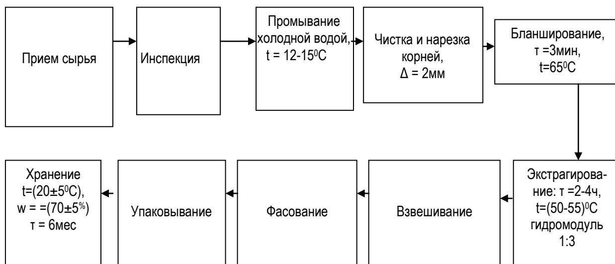
Рис. 5. Технологическая схема производства экстрактов из дикорастущего сырья
